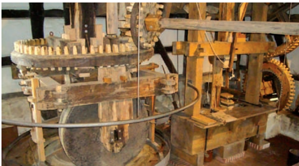
Kollergang und Stempelpres- sen der Ölmühle Lonnerbecke in Bippen (Niedersachsen)
